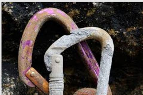
Mosquetão que sofreu desgaste por abrasão e provavelmente exposição a algum produto alcalino que contém soda, potassa, etc, como: água sanitária, alvejantes, cloro, etc.
